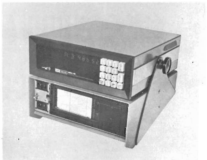
Fig. 14 - Un ricevitore per il più moderno metodo di radionavigazione: il sistema OMEGA (Modello 300). Frequenza 10,2 kHz, sensibilità migliore di 0,1 \mu V/m, larghezza di banda 100 Hz, ricerca automatica e simultanea di tutte le stazioni ricevute. (ITT).
