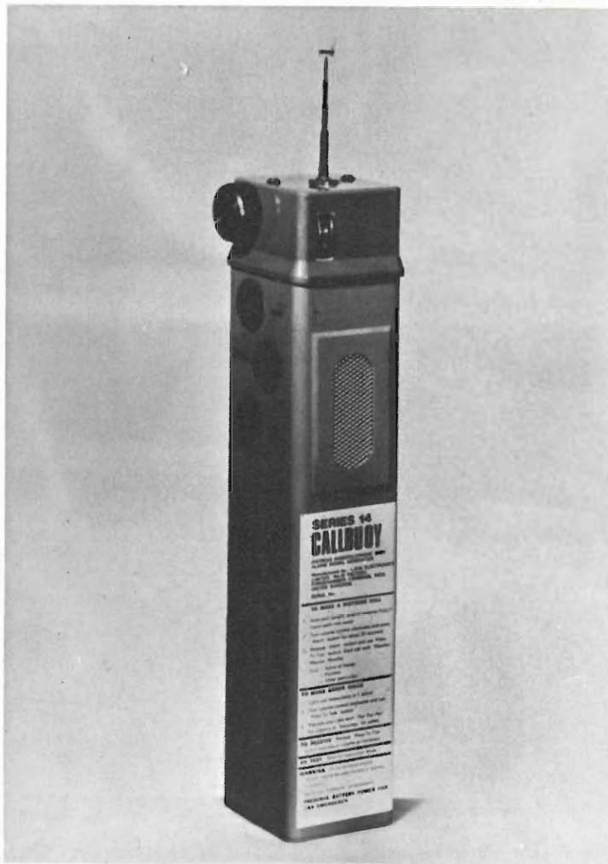
Fig. 8 - Un radiotelefono di emergenza indispensabile per coloro che in questa stagione si dedicano alla navigazione da diporto. Funziona su 2182 kHz, cioè la frequenza di soccorso. (Finder).
