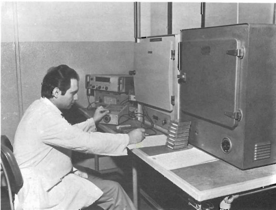
Fig. 6 - La moderna attrezzatura con la quale i gruppi selettori VHF-UHF vengono sottoposti ai controlli per la determinazione del fenomeno di deriva termica.
