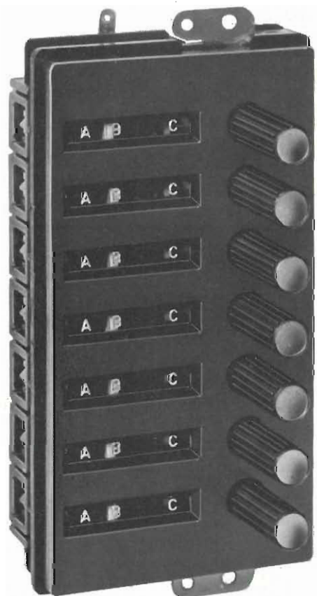
Fig. 27 - La tastiera potenziometrica modello P7 si distingue dal modello P4 unicamente in quanto dispone di un maggiore numero di pulsanti, che consente in questo caso la selezione automatica di sette diversi canali.
