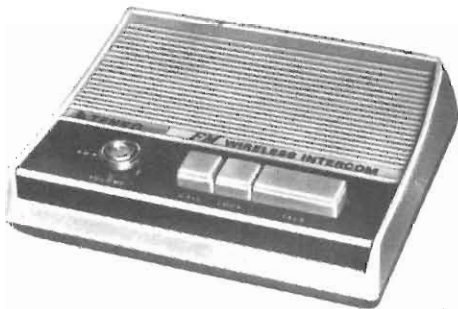
Fig. 4 - Interfonico ad onde convogliate Tenko modello NF-801 (GBC ZR/6100-00). Potenza di uscita 500 mW, alimentazione 220 Vca.
